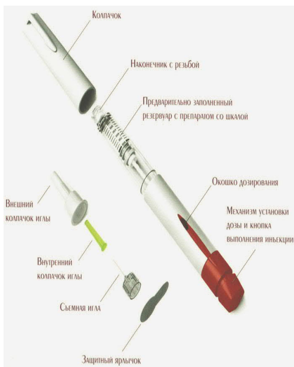
Рисунок 19. Строение иглы и шприц ручки
